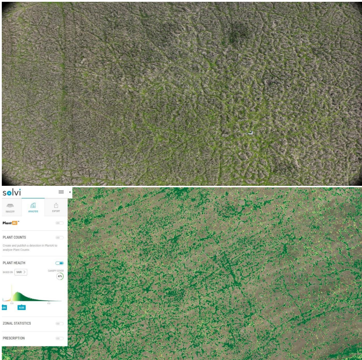
Figur 1. Den övre bilden visar en drönbild över ett vårkornfält inför skörd. De gröna gångarna i grödan har orsakats av vildsvin. Den nedre bilden är en bearbetad sammanställning av samtliga drönbilder i Solvi, där en analys av grönytäckningen har gjorts för att beräkna andelen skadad gröda. I det här fallet motsvarar grönytäckningen, alltså viltskadorna, upp mot cirka 47 % av fältet.
